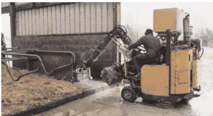
Rainureuse automotrice. Modèle Vermot, avec bras articulé pour intervenir dans les endroits difficiles.
