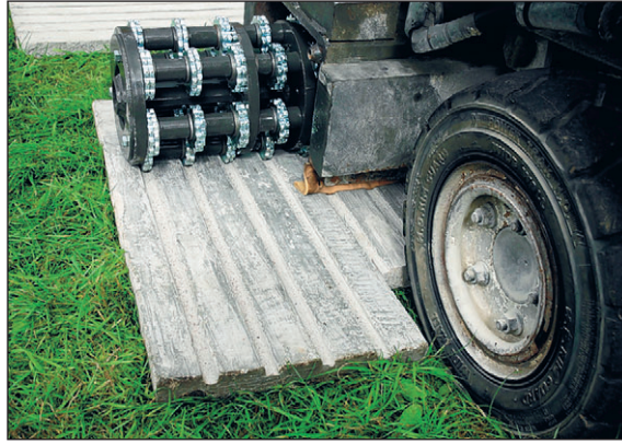
Les rotors tracent des rainures tous les 55mm. Leur largeur est de 18mm; leur profondeur, de 10 à 13mm.
